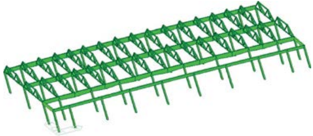
Figura 20 Forma modale n. 1 del Capannone 2 e 3 [T = 0.67 s].
