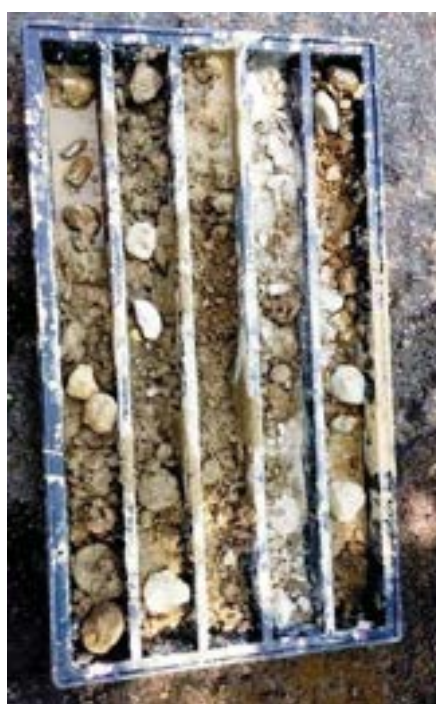
Figura 10 Sondaggio a carotaggio continuo.
