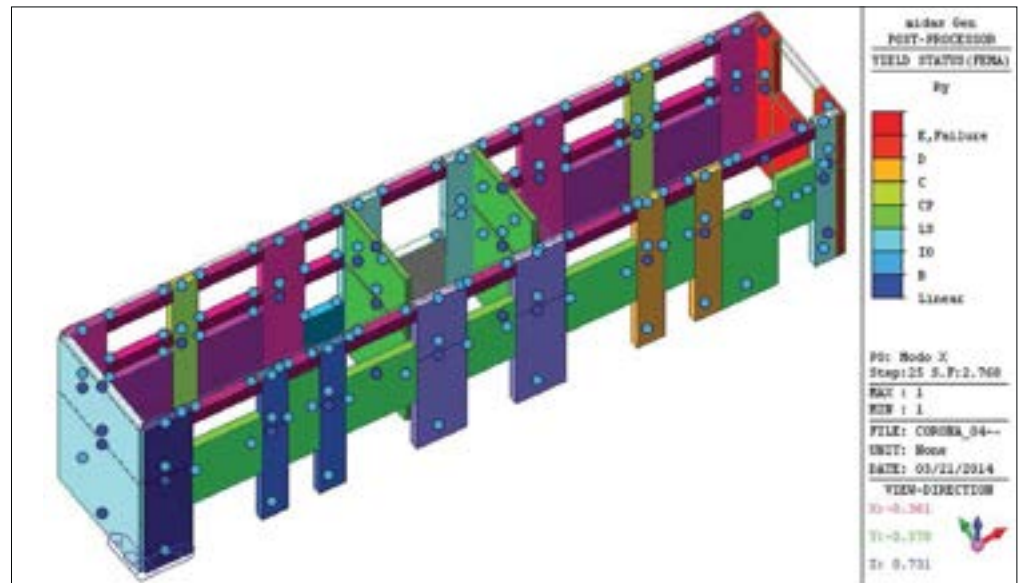
Figura 28 Stato di plasticizzazione delle cerniere plastiche, Fabbricato B - Gruppo 2, direzione longitudinale step 25.
