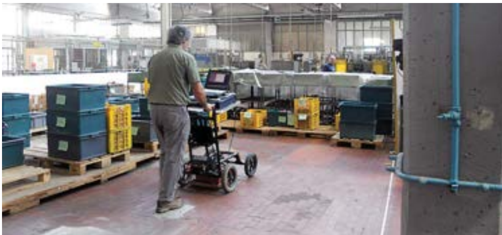
Figura 8 Indagine geosica con metodologia GPR (Ground Probing Radar).
