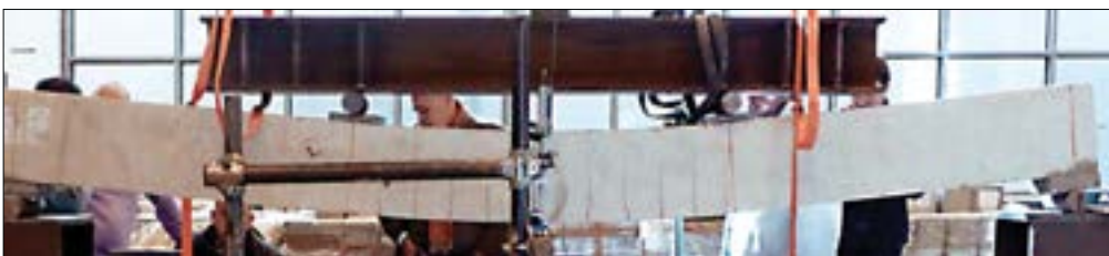
Figura 5 Trave flessa durante il test.
