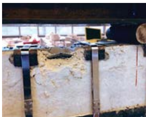
Figura 19 Rottura corrente compresso (a sinistra).
