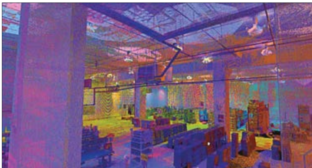
Figura 8 Rilievo con nuvola di punti di un complesso industriale (Bentley Point Cloud).
